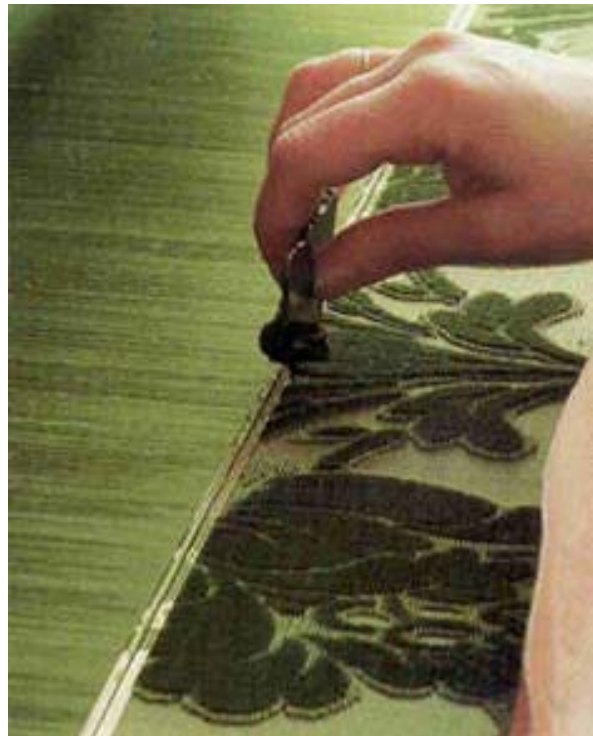
On voit ici le veloutier en train de couper le fer de coupé à l'aide du rabot... Remarquez, sur le tissu, le velours frisé (boucles) moins haut que le velours coupé, et lisérant ce dernier.
