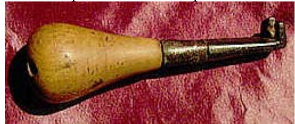
Cet outil permet d'arracher les fers de velours frisé
